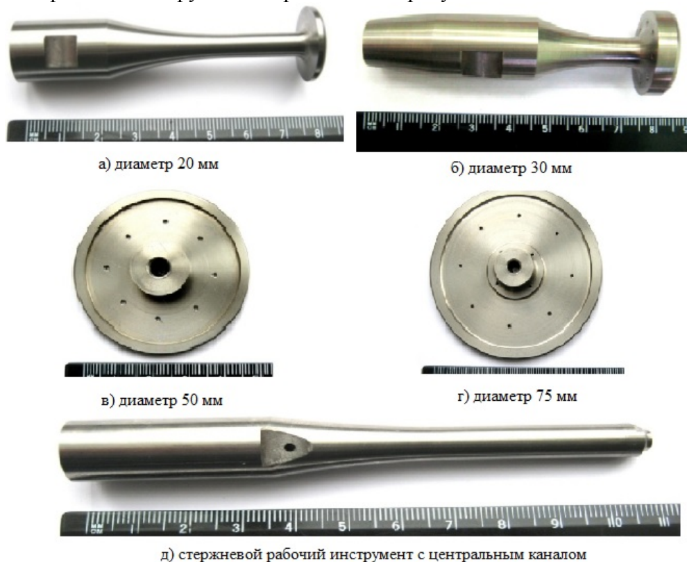
Рис.5. Изготовленные рабочие инструменты: а,б – стержень с дисковым окончанием; в,г – изгибно-колеблющийся диск; д – стержень с центральным каналом
