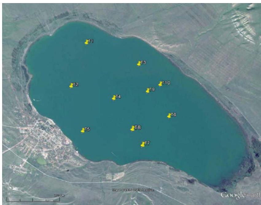
Рис. 1. Расположение термисторных цепей в 2015 году.
