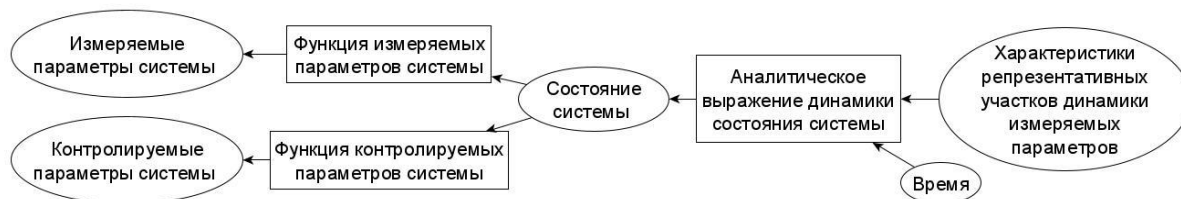
Рис. 3. Преобразованная аналитическая модель системы, применимая для решения практических задач
