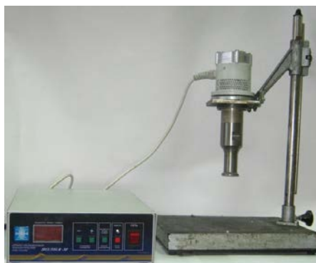
Рис. 3. Экспериментальный стенд для выявления зависимости объема зон развитой кавитации от расстояния между излучателем и отражающей границей
