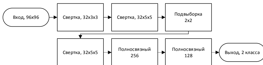
Рис. Схема сети бинарной классификации. Пунктирными линиями показан переход между слоями, в которых при обучении отбрасывается часть нейронов (dropout). Форма сверточных слоев записана как (число ядер)x(ширина ядра)x(высота ядра).
